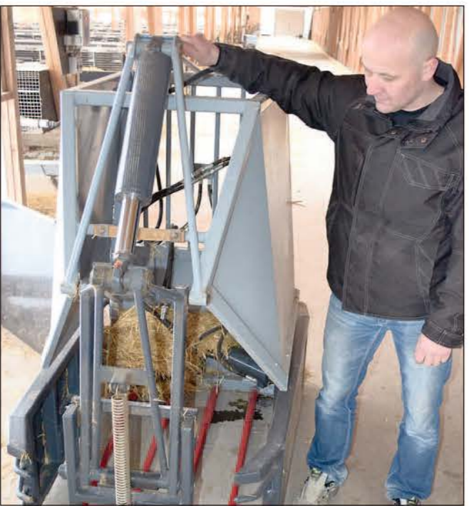
En halmsamler fremstillet af højstyrkestål er en af de nyheder, Thyrrstrup Mink viser på Skindudstillingen i Herning. Den monteres let på en minilæsser. Foto: Einar Bo Thomsen.
